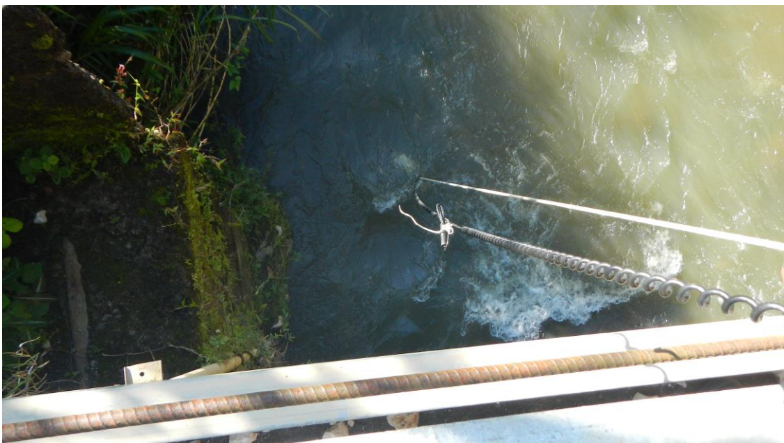
Figura 5. Aforo y técnica de recolección del agua en el cauce del río Caño Seco.
