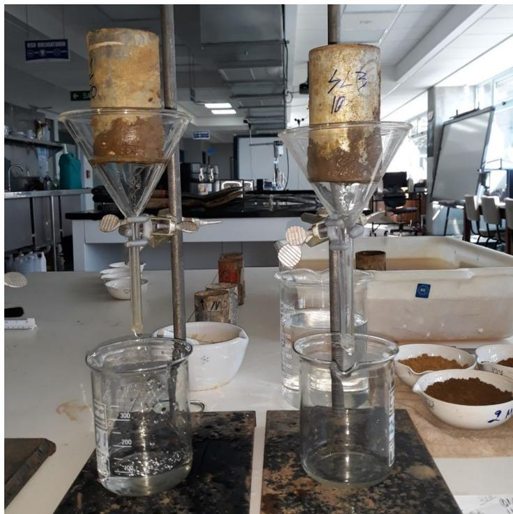
**Figura 3.** Método de experimentación para el cálculo de conductividad hidráulica mediante la ley de Darcy, el cual mide el flujo de líquidos en medios porosos. Los horizontes analizados mediante esta técnica fueron 10 cm, 30 cm y 50 cm, debido a su naturaleza de mejor permeabilidad.
